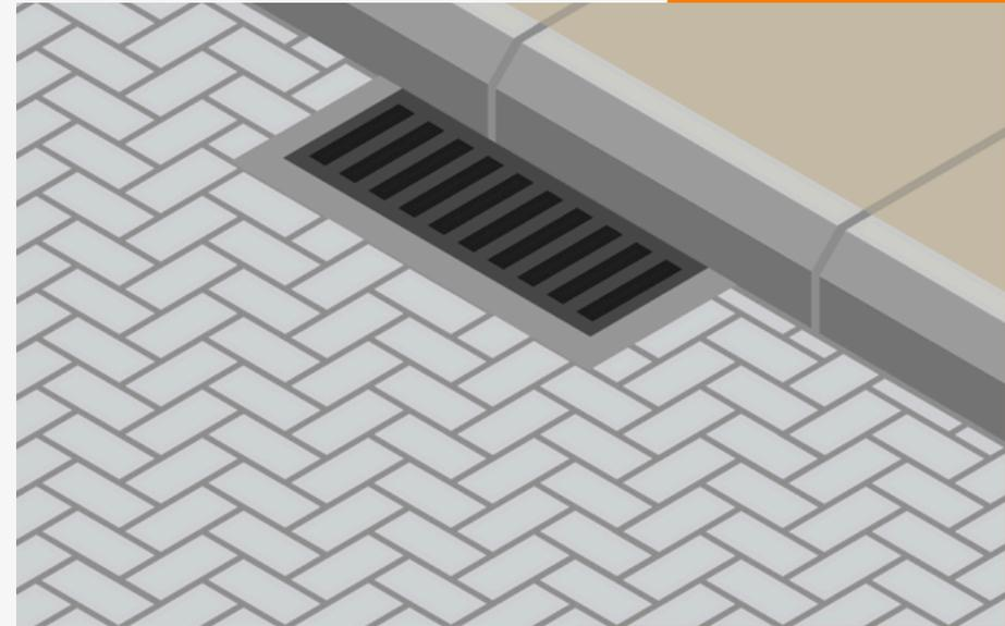
Cabe señalar que la colocación de adoquines no necesita respetar una modulación por lo que se pueden realizar cortes en los mismos mediante una amoladora, para adaptarse a la aparición de rejillas de desagües, o a bordes irregulares. Cuando se produce un encuentro con otro tipo de pavimento, se deberá construir un cordón transversal.
